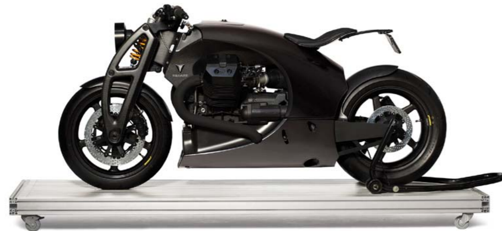
CSI Composite Solutions on kehittänyt virolaisen Renard Motorcyclesin kanssa hiilikuituisen moottoripyörän rungon.
